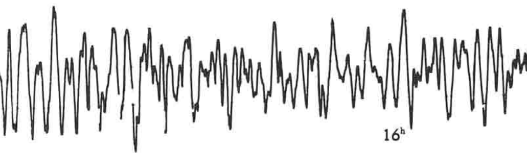
Fig. 15 - Uninodali e binodali registrate con ampiezze molto accentuate nella parte settentrionale del lago.
