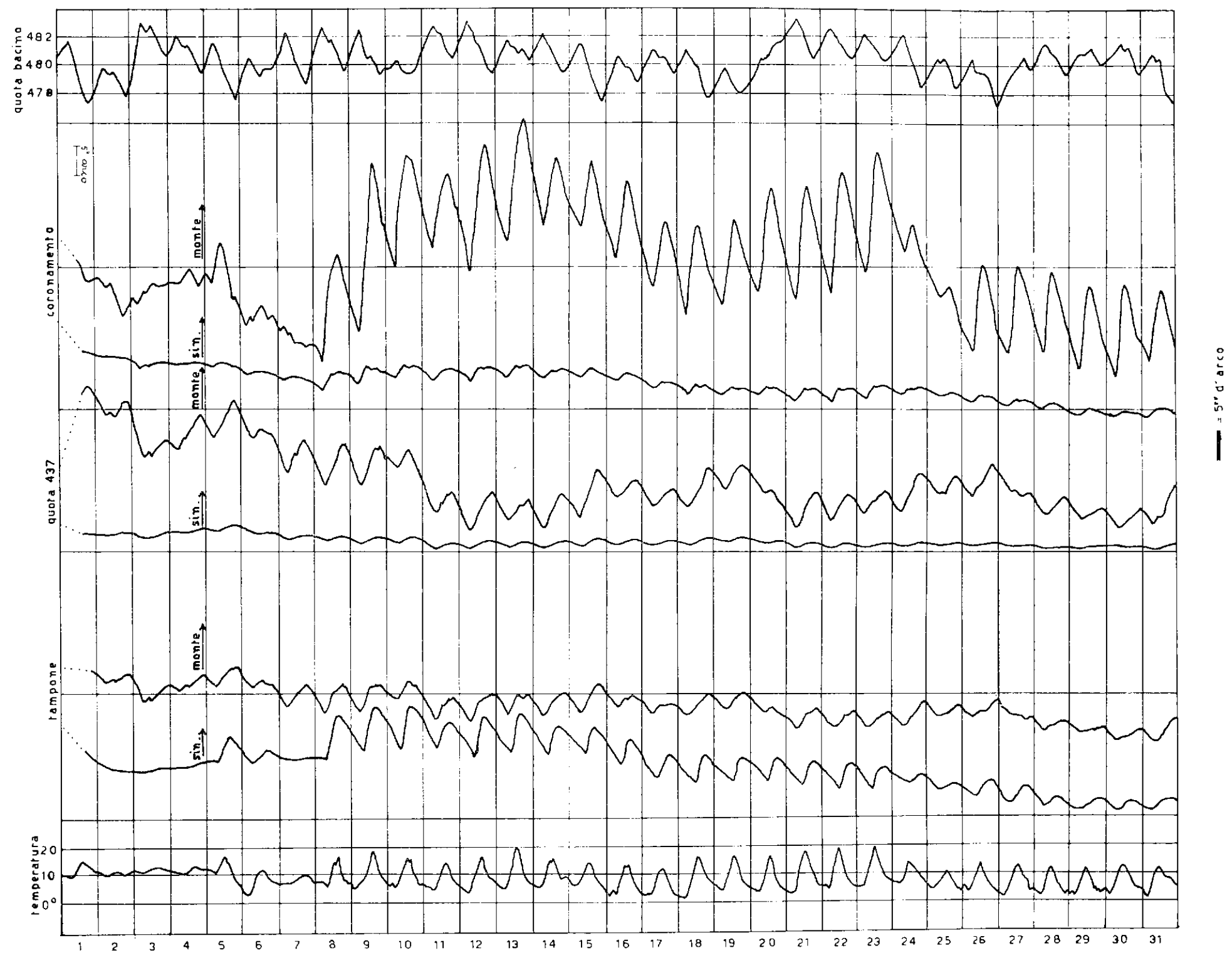
Fig. 12 - Confronto delle registrazioni clinografiche ottenute al coronamento, a quota 437 (base del conico centrale) e a un metro sotto (tampone), presso la diga dell'Anbiesta, con le variazioni di temperatura e invaso (Ottobre 1963). Si legga, nel testo, l'interpretazione di queste registrazioni.
