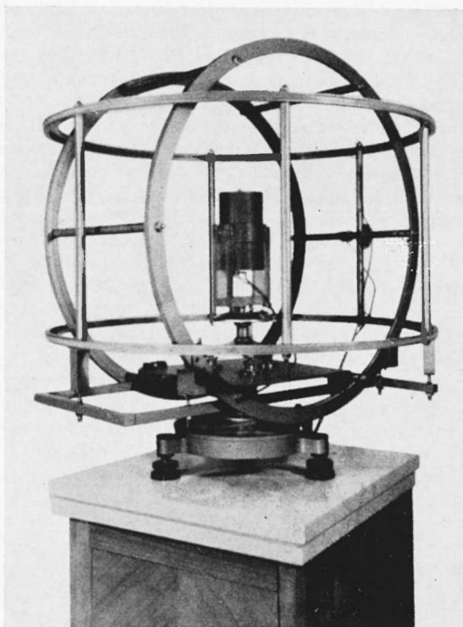
Fig. 3 - Sistema di bobine Helmholtz e sensore del magnetometro a protoni (tipo ELSEC).
