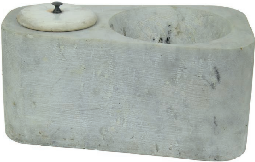
Fig. 2 - Atmidometro Galli, evaporimetro di originale concezione progettato dallo scienziato veliterno. In un blocco di marmo, due fori cilindrici sono fra loro comunicanti: il più grande viene riempito di sabbia molto fine, mentre l'altro di acqua; per capillarità, l'acqua salirà fino alla superficie libera della sabbia. Per mettere in funzione lo strumento si integra il livello dell'acqua del vaso piccolo; l'acqua che, in un determinato intervallo di tempo, evaporerà dal vaso grande, sarà integrata automaticamente per capillarità. Misurando l'acqua che occorrerà aggiungere nel vaso piccolo per ripristinare l'originale livello, si otterrà la quantità di acqua evaporata nell'intervallo di tempo considerato. Originale conservato nella collezione museale del Consiglio per la Ricerca in Agricoltura e l'analisi dell'Economia Agraria (CREA)
